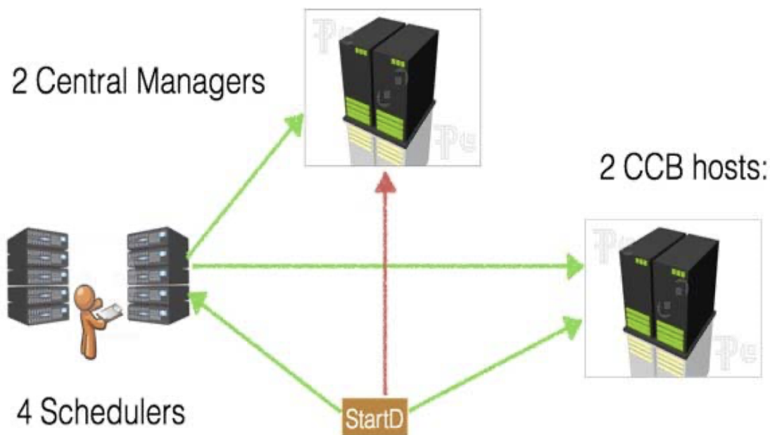
Obr. 1.11: Architektúra HTCondor pre viac ako 100k paralelných úloh [13]
