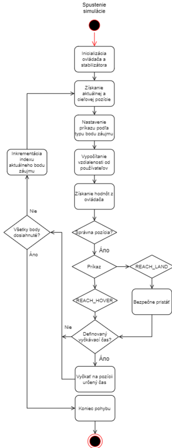
Obr. 5.11: Diagram aktivít zobrazujúci proces riadenia drona pomocou ovládača navrhnutého pre kvadrokoptéru
