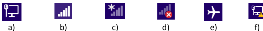
Obr. 11 Ikony indikujúce stav pripojenia k sieti: počítač je pripojený k sieti Ethernet káblom (a), počítač je pripojený k Wi-Fi sieti (b), počítač nie je pripojený k sieti a pripojenia sú k dispozícii (c) resp. nie sú k dispozícii a Wi-Fi je zapnutá (d) alebo vypnutá Režimom Lietadlo (e) a počítač je pripojený káblom no je problém s pripojením (f).
