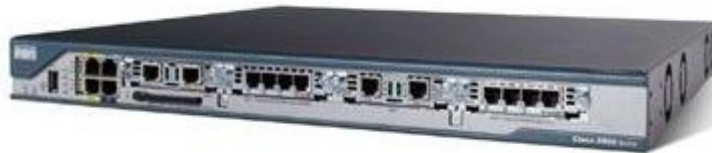
Obrázok 3 Smerovač od spoločnosti Cisco, séria 2800, zdroj: Cisco
