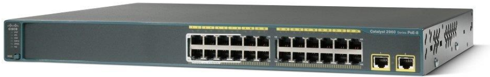
Obrázok 2 Prepínač od spoločnosti Cisco, typ 2960, zdroj: Cisco
